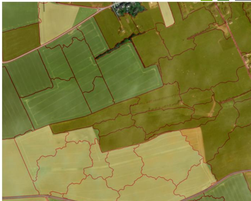
Illustration 5. Exemple où la segmentation du TOP10V propose des polygones très grands et une segmentation qui ne correspond plus à l'occupation du sol actuelle : à gauche, les écotopes et à droite, le TOP10V. Les écotopes proposent une segmentation correspondant à l'occupation du sol, en identifiant correctement les prairies et les cultures.
