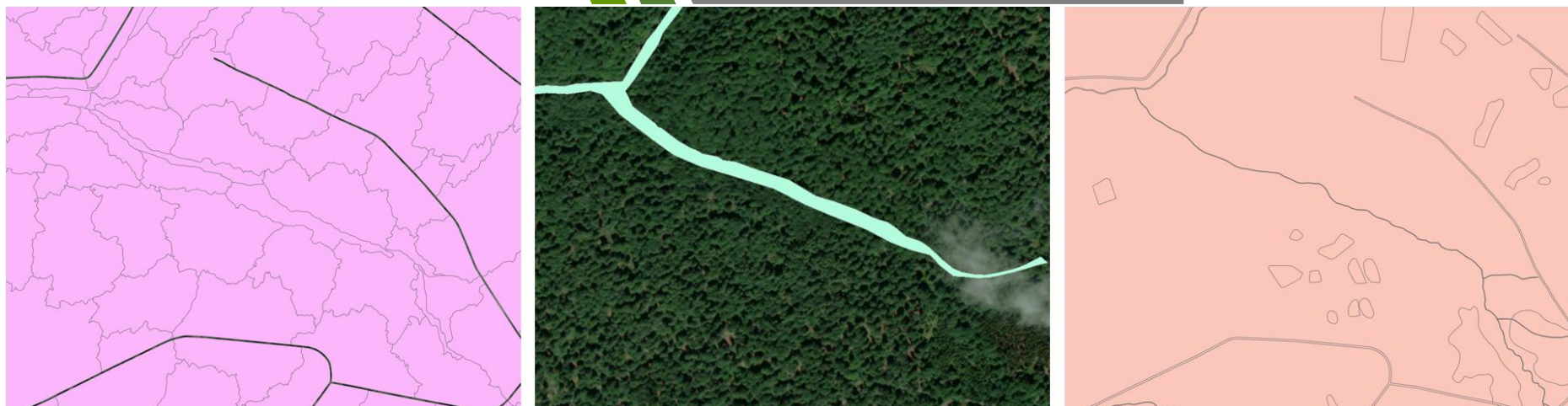
Illustration 4. Exemple de situation où les écotopes et le TOP10V ne permettent pas d'identifier le fond de vallée autour du ruisseau dans une vallée ardennaise : à gauche, les écotopes, au milieu, les aléas d'inondation et l'orthophoto, à droite, le TOP10V. Cet exemple montre l'intérêt de prendre en compte les aléas d'inondation dans le référentiel cartographique.
